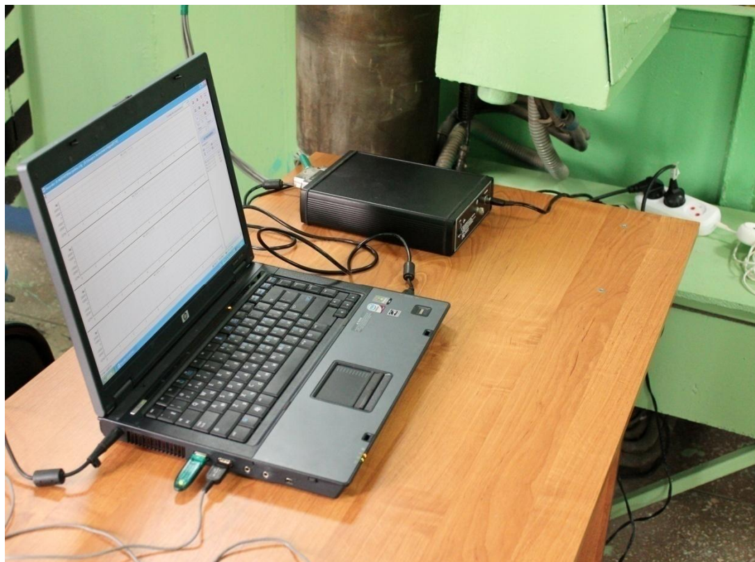
Рисунок 3.4 – Регистрация и обработка данных о нагрузках, возникающих при работе бульдозера-смесителя
