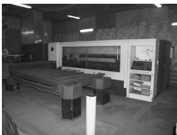
Рисунок 5.9 – Общий вид лазерной установки с приспособлениями для обработки деталей
