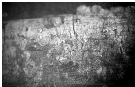
Рисунок. 4.17 – Разрушение КЭП железо-карбид бора при высокотемпературном нагреве (900...1000°C) ( \times 200 )
