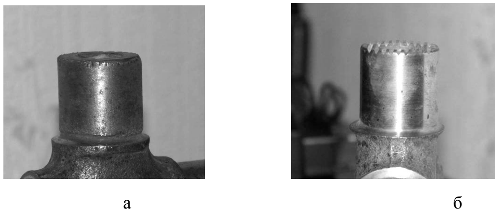
Рисунок 5.15 – Общий вид шипа восстановленной крестовины до (а) и после (б) финишной механической обработки
