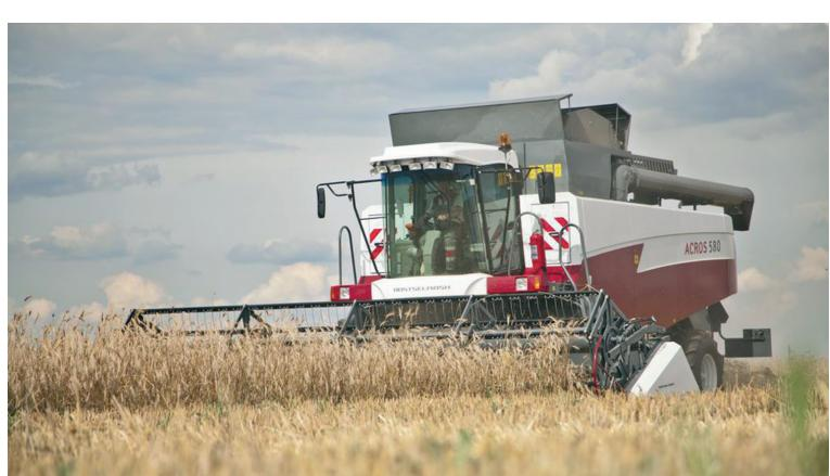
жит уникальная запатентованная система обмолота Advanced Rotor System (ARS). Благодаря ARS TORUM не травмирует зерно, отлично справляется даже с влажной и засоренной массой. Система состоит из трех элементов – это битерная наклонная камера, которая обеспечивает увеличение пропускной способности на «сложном» фоне на 20%, по сравнению с традиционными транспортерными; аксиальный ротор с врачающейся декой, который позволяет избежать «мертвых» зон и вести обмолот на збо-
