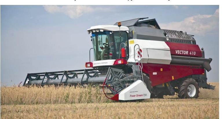
Кроме того, комбайн может быть оборудован копнителем вместимостью 12 куб. м. Таким образом, в своем классе только VECTOR может предложить такое разнообразие схем работы с незерновой частью урожая: солому можно не только измельчать и разбрасывать или укладывать в валок, но и собирать в копны, автоматически выгружая их на ходу.
