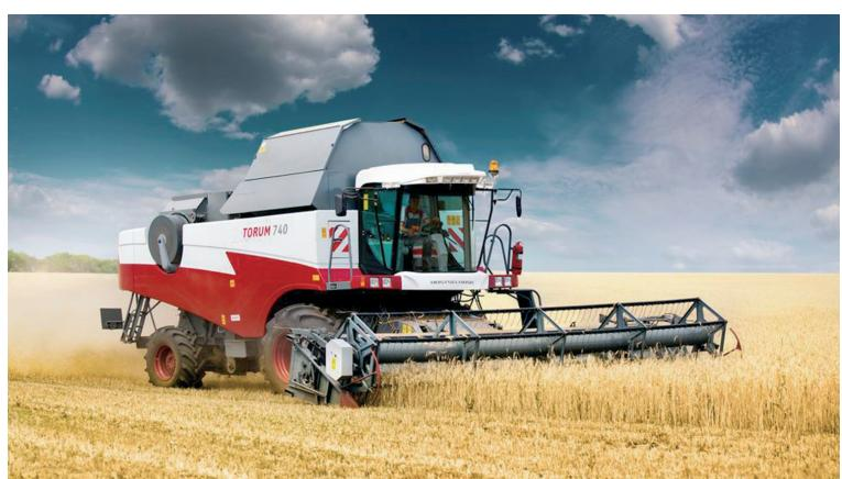
градусов; бесступенчатый привод ротора, благодаря которому можно осуществить быструю и точную подстройку параметров обмолота, максимально приспособливая комбайн к условиям уборки. Ротор, установленный в TORUM, – один из самых крупных в мире: диаметр – 762 мм, длина – 3200 мм. Вкупе с врачаю-
