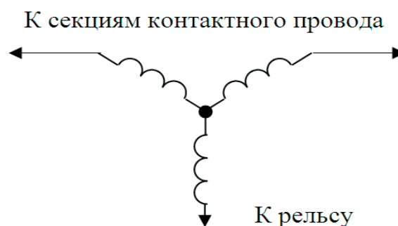
Рис. 1. Схема подключения вторичной обмотки тягового трансформатора
