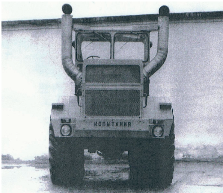
Рис. 3. Общий вид газотурбинного трактора К-701 «ТУРБО»
