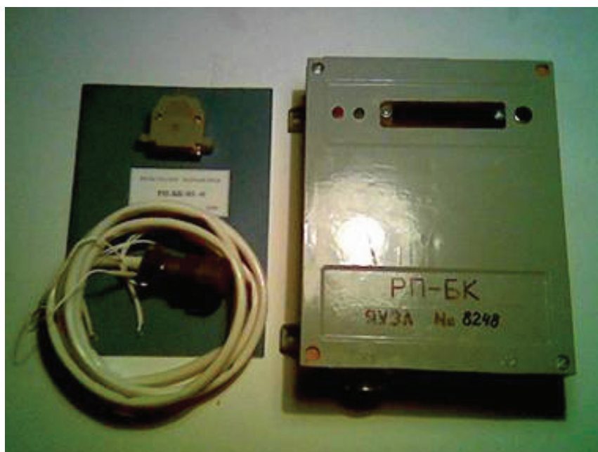
Рис. 5. Автономный регистратор параметров РП-ГМ
