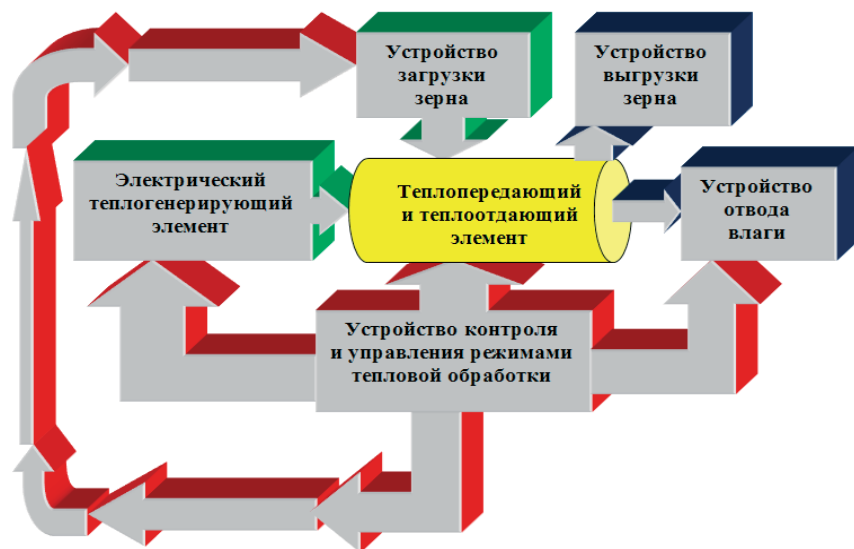
Рис. 6. Структурная схема электроконтактной установки для тепловой обработки зерна
