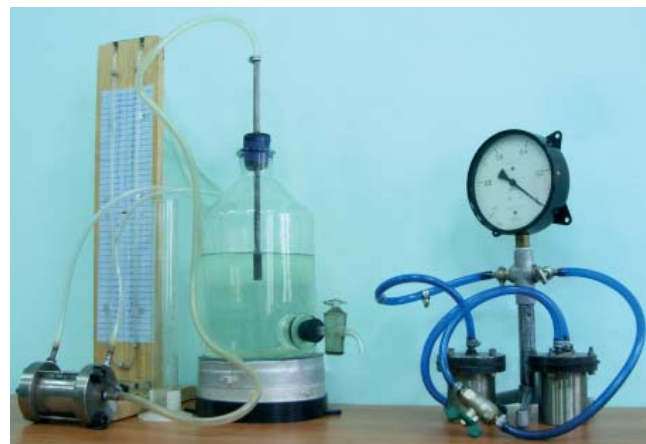
Рис. 2. Аэродинамический периметр (слева) и устройство для определения пористости (справа)
