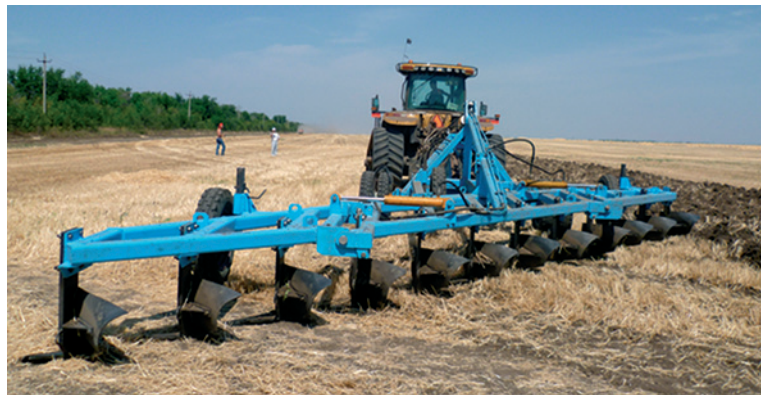
Рис. 1. Прицепной плуг ПБС-12П в агрегате с трактором «Challenger» MT 865 B
